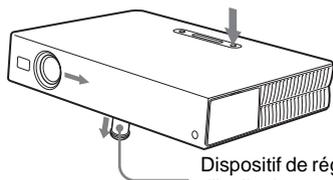
Dispositif de réglage d'inclinaison motorisé
