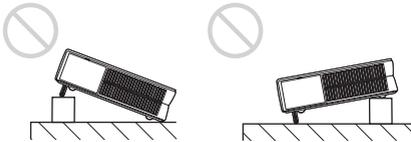
Evite utilizar la unidad con una inclinación que se encuentre fuera del margen de regulación del ajustador. Una instalación así puede provocar sombras de color o acortar excesivamente la vida de la lámpara.
