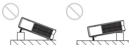
Évitez d'utiliser cet appareil lorsqu'il est incliné en dehors des limites du support réglable. Une telle installation pourrait provoquer des taches de couleurs ou raccourcir excessivement la durée de service de la lampe.
