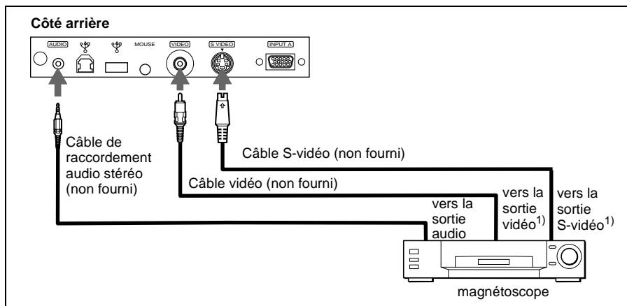
1) Si vous raccordez un appareil externe simultanément aux prises S VIDEO et VIDEO, c'est le signal transmis via la prise S VIDEO qui est sélectionné.
