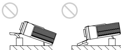
Instale la unidad únicamente sobre el suelo. Evite utilizar la unidad inclinada hacia arriba o abajo. Esta instalación puede causar fallos de funcionamiento.
