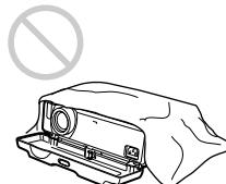
Evite emplear algo que cubra los orificios de ventilación (exhaustación/aspiración); en caso contrario, es posible que se produzca recalentamiento interno.
