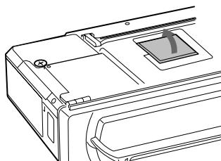
**3** Extraiga la cubierta del filtro de aire.
