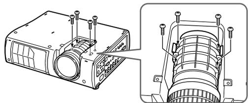
**11** Utilice los dos tornillos (M3×8, plateados) para montar la cubierta inferior del objetivo quitada sobre el objetivo en la orientación mostrada en la figura de abajo.
