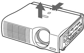
**4** 用菲立浦螺丝刀卸下固定透镜的4颗螺钉
