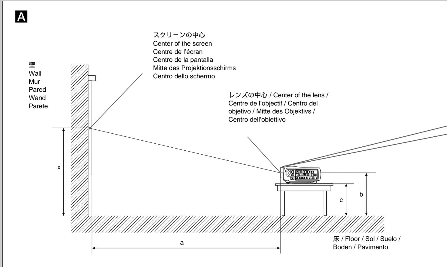
プロジェクターを机などの上に置いて設置する場合の設置例を示します。A
