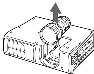
**6** 交換するレンズ側のストッパーをプロジェクター本体側のストッパーに押し当てる様にして位置を合わせ、レンズを組み込む。
