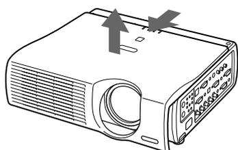
**4** Retirez les quatre vis (M3×10, avec rondelles) de maintien de l'objectif.
