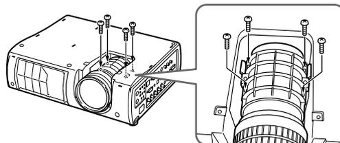
11 はずしたレンズボトムカバーを、レンズの上に図示向きに2本のネジ(M3×8、銀色)で取り付ける。
