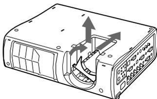
9 レンズ側のストッパーを Projektor 本体側のストッパーに押し当てるようにして位置を合わせ、レンズを組み込む。
