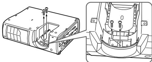
8 レンズボトムカバーの左側を持ち上げて傾け、そのまま右側に寄せて、その状態のまま右上方向に取り外す。
