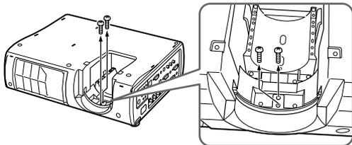
**8** Levante e incline el lado izquierdo de la cubierta inferior del objetivo, muévala hacia el lado derecho, y a continuación retírela en dirección hacia la derecha y arriba mientras la mantiene inclinada.
