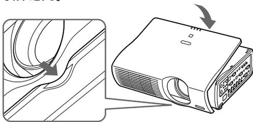
9 将顶盖向后滑动直至接触到后侧为止。
