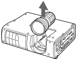
6 図示した左右のスペーサーの4本(M3×6、黒色)のネジをプラスドライバーではまずし、取り除く。
