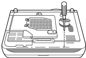
**3** 将顶盖（透镜头盖）向前滑动，然后抬起将其取下。
