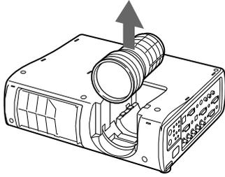
6 将新透镜的挡块与投影机挡块彼此接触来对齐其位置，然后安装透镜。
