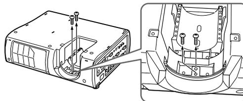
**8** 抬起并倾斜透镜底盖左侧，使其朝向右侧，然后保持这一倾斜状态沿向右上的方向将其取出。
